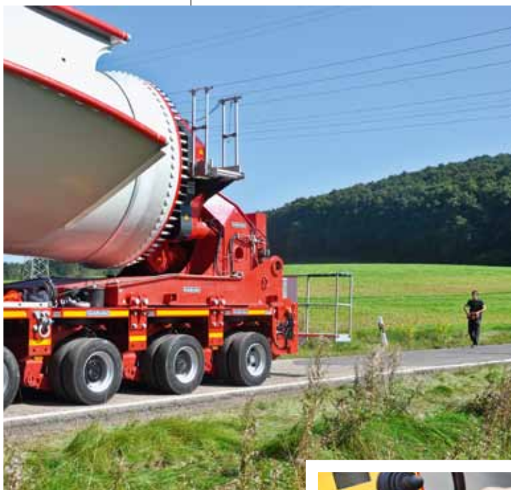
Randolf Peters steuert den Selbstfahrer mit einer Fernbedienung.
